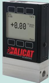
30 系列压力传感器测量过程系统内任意点气体或液体的绝压 (真空) 或表压 (本地大气压)。这种在线设计允许量化流动过程的压力, 且无需将系统端部封闭。
